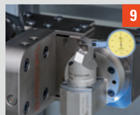
Einmessen Werkzeug tool calibration
