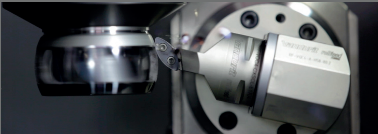
Kugelkäfig (Hartdrehen) Feinschlichten | ball cage (hard part turning) fine-finishing
