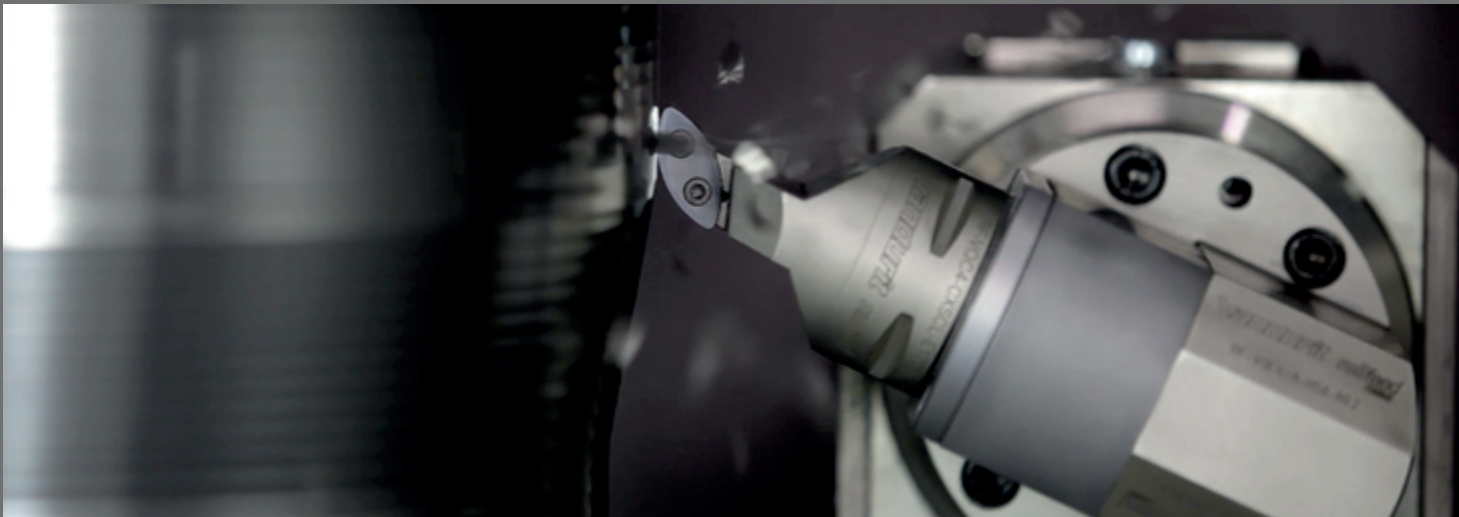
Zylinderlaufbuchse (Gusszerspanung) Vorschlichten | cylinder liner (cast iron machining) pre-finishing
